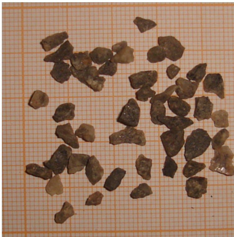
Figura 16. Material retido na peneira de abertura 2,36 mm – resíduo de britagem lavado.
