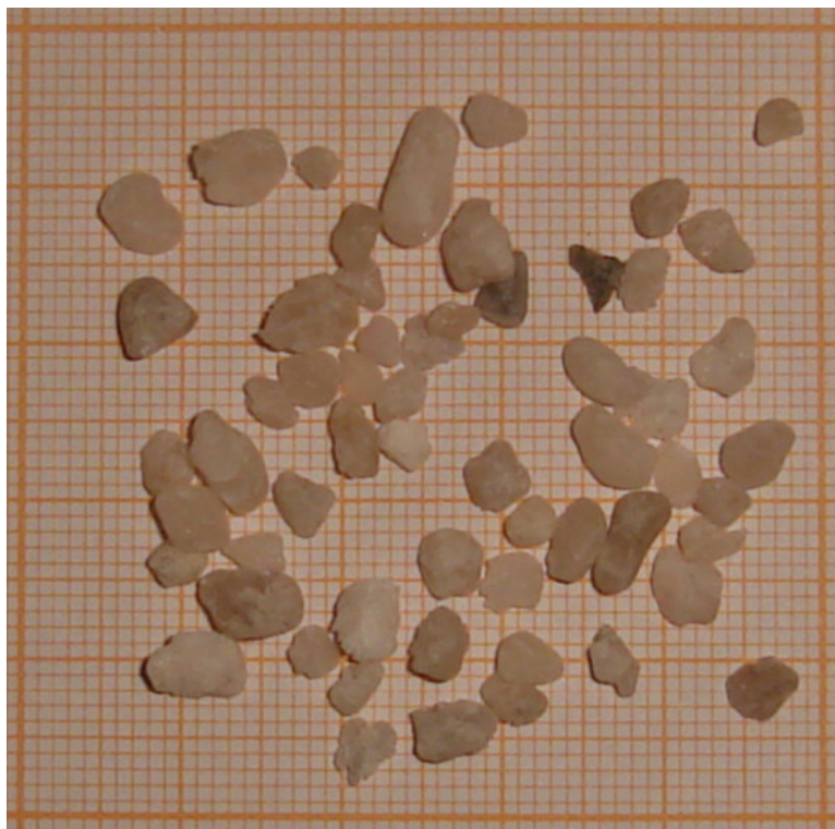
Figura 14. Material retido na peneira de abertura 2,36 mm – areia natural.
