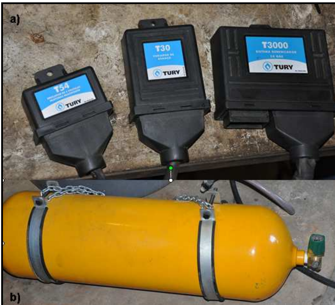
Figura 16 – “kit” de conversão para utilização do gás natural veicular. a) Módulos eletrônicos do “kit” utilizado. b) Cilindro de GNV.
