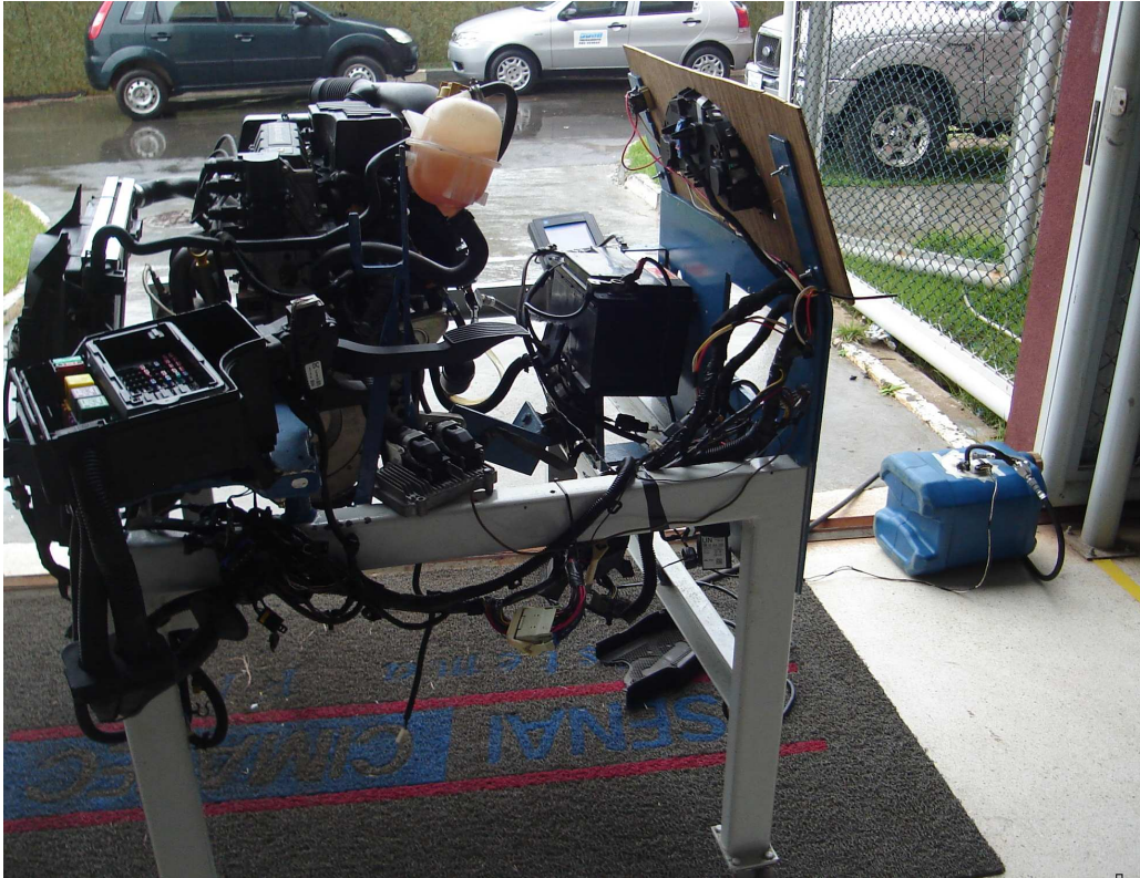
Figura 14 – “Mocape” com o motor de combustão utilizado nos ensaios.
