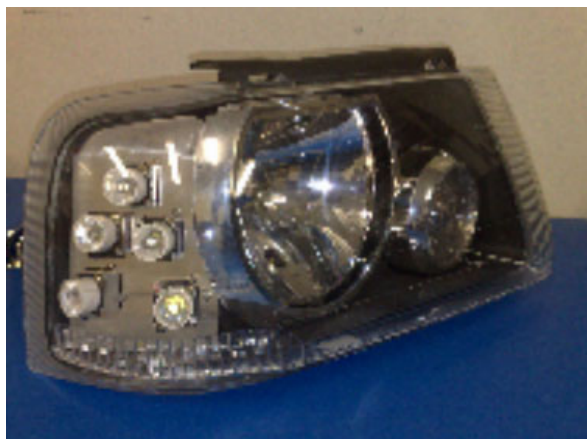
Figura 1 - Protótipo de um AFS utilizando LEDs com acionamento controlado para iluminação auxiliar lateral
