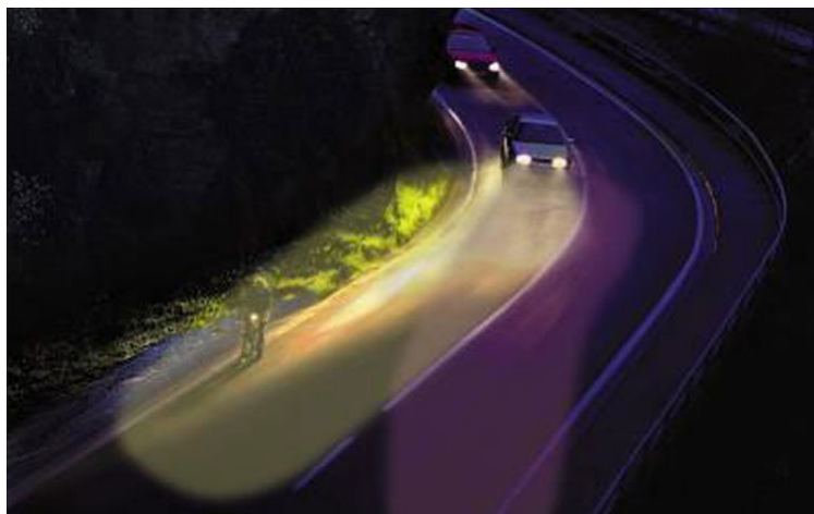
Figura 5 - Demonstração da atuação de um sistema de iluminação adaptativa permitindo que o condutor visualize um ciclista em uma curva
