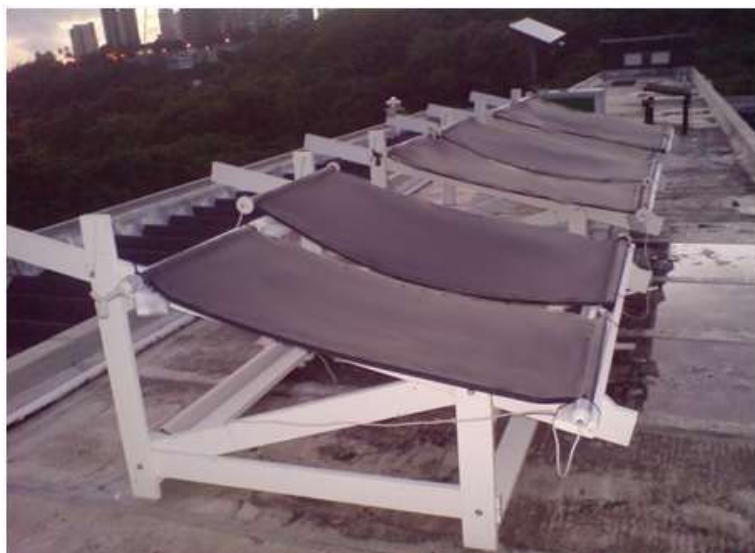
Figura 3.20 – Disposição das placas solares térmicas durante os testes.
