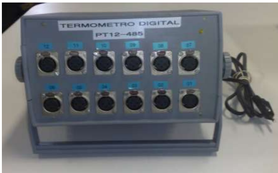
Figura 3.9 – Caixa eletrônica 1: Módulo de aquisição de sinais e transmissão de dados.
