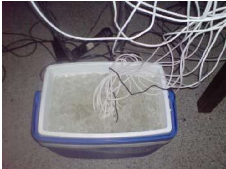
Figura 3.13 – Coolerbox contendo água, gelo, sensores PT-100 e termômetro digital Ti-33 (cabo preto).
