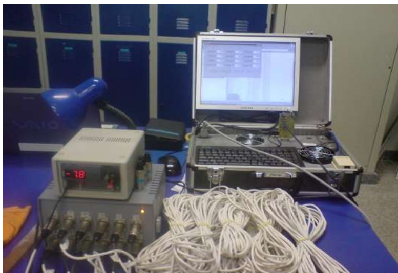
Figura 3.11 – Sensores de temperatura sendo calibrados. Na esquerda, o termômetro Ti-33, o multi-termômetro com os PT-100, na direita o computador pessoal.
