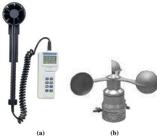
Figura 2.27 – (a) Anemômetro digital de hélice. (b) Anemômetro do tipo concha.
