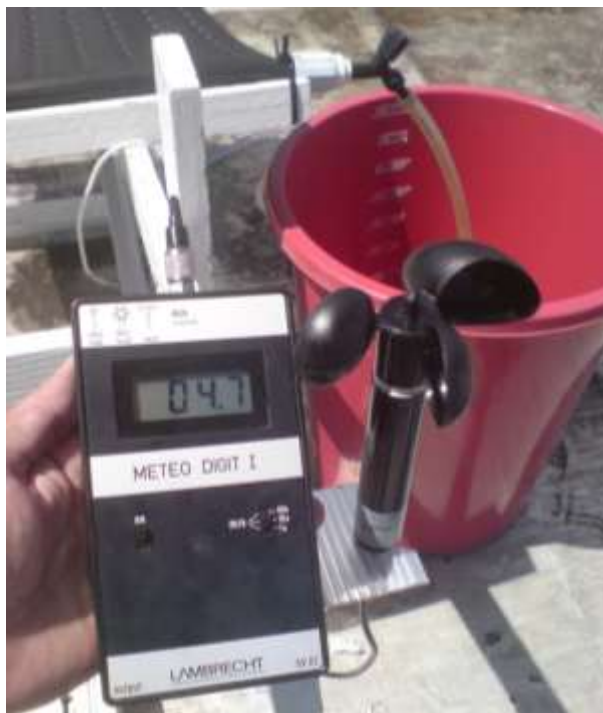
figura 3.18 – Anemômetro instalado na plataforma experimental.
