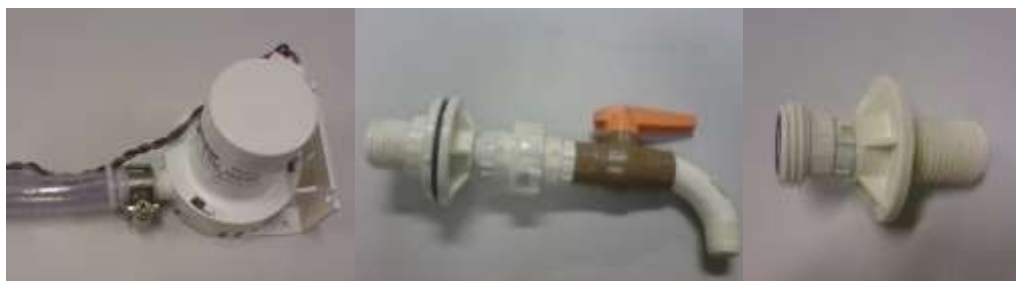
Figura 3.4 – Elementos de PVC utilizados para conexões hidráulica das placas solares.
