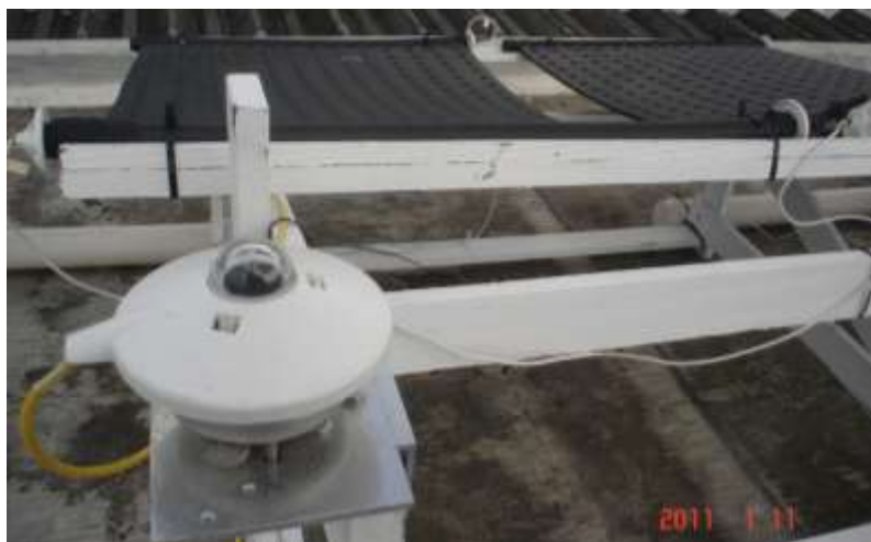
Figura 3.16 – Piranômetro da Kipp & Zonem á frente e coletores solares ao fundo.
