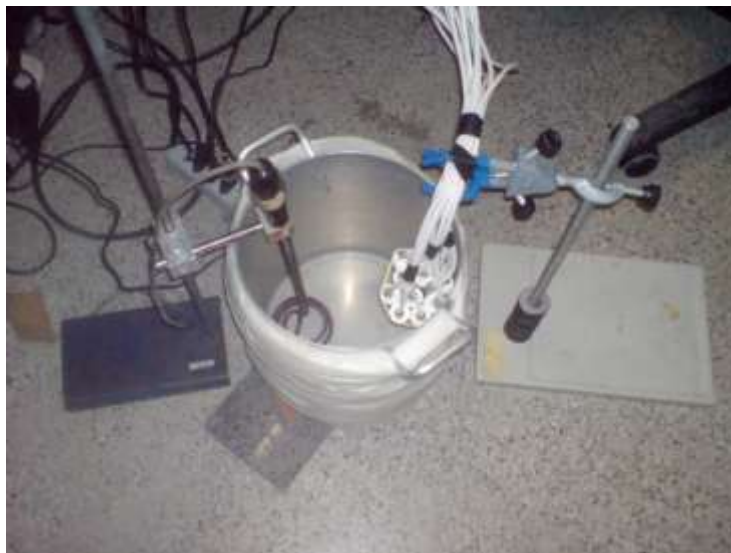
Figura 3.12 – Pt-100, mergulhão e termômetro digital Ti-33 em um caldeirão isolado.
