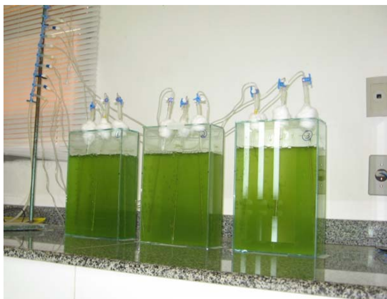
Figura 3.3 - Sistema reacional: Reator Placa.
