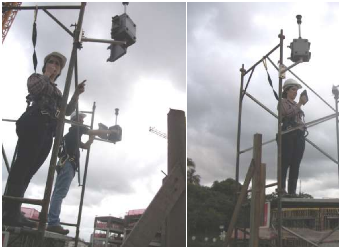
Figura 31: Substituição das baterias dos MiniVols
