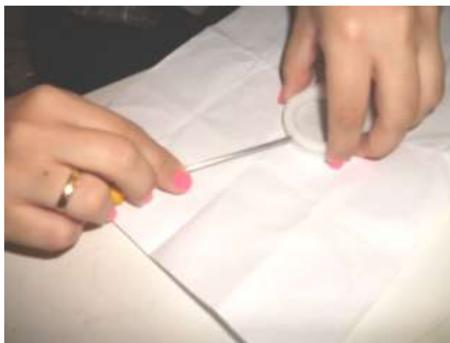
(b) retirada dos filtros dos cassetes
