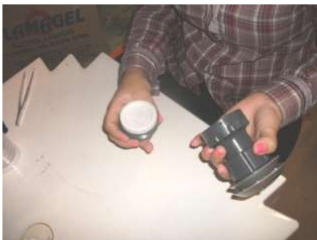
(a) abertura dos coletores para retiradas dos filtros
