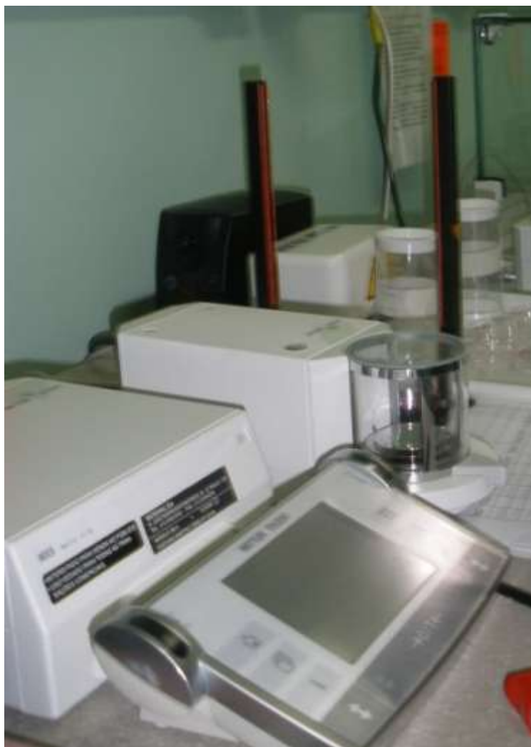
Figura 18: Balança analítica Mettler Toledo do LAPAT/IAG/USP
