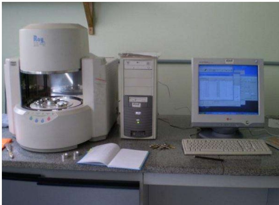
Figura 19: Equipamento de Fluorescência de Raio-X modelo EDX 700 HS “Energy Dispersive X-Ray Spectrometer” da Shimadzu do LAPAT/IAG/USP
