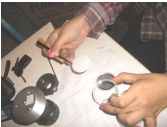
(c) transporte do filtro do cassete para a placa petri
