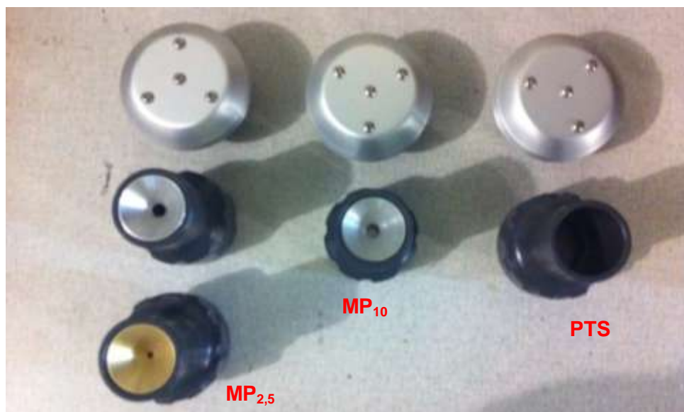
(a) Coletores abertos para 2,5µm, 10µm e PTS.
