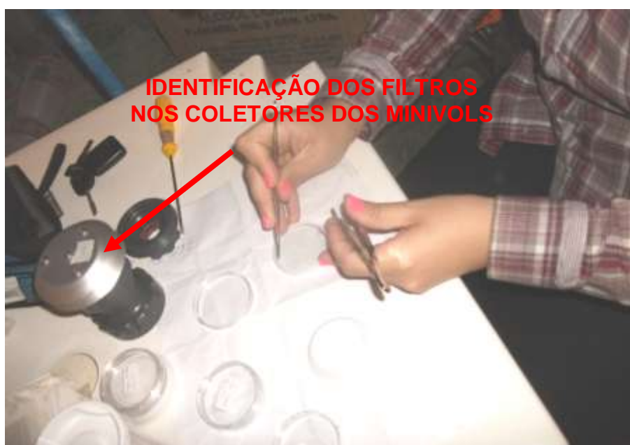
Figura 33: Alocação dos novos filtros nos coletores dos MiniVols
