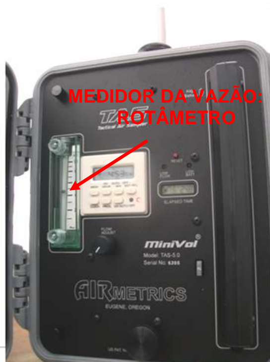
Figura 30: Vazão final do MiniVol
