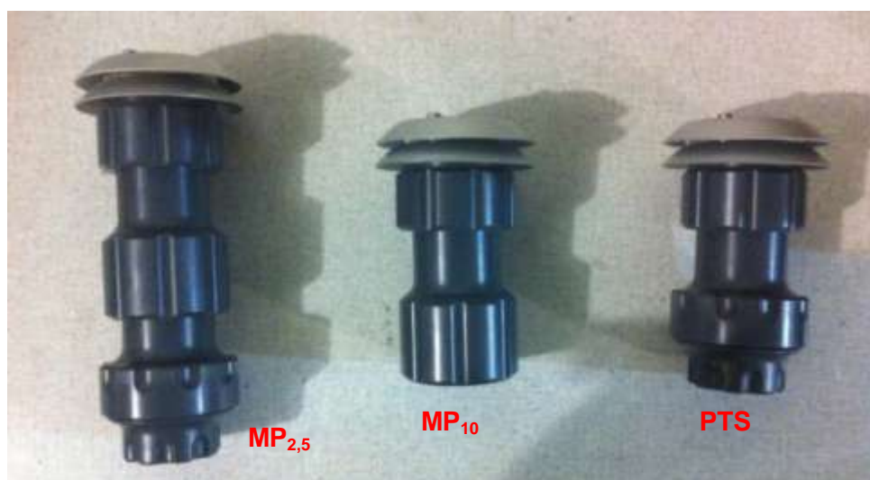
(a) Coletores fechados para 2,5µm, 10µm e PTS.
