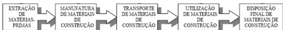
FIGURA 1: Principais etapas do ciclo de vida de materiais de construção Fonte: adaptado de (SPERB e SATTLER, 2001, p.4).
