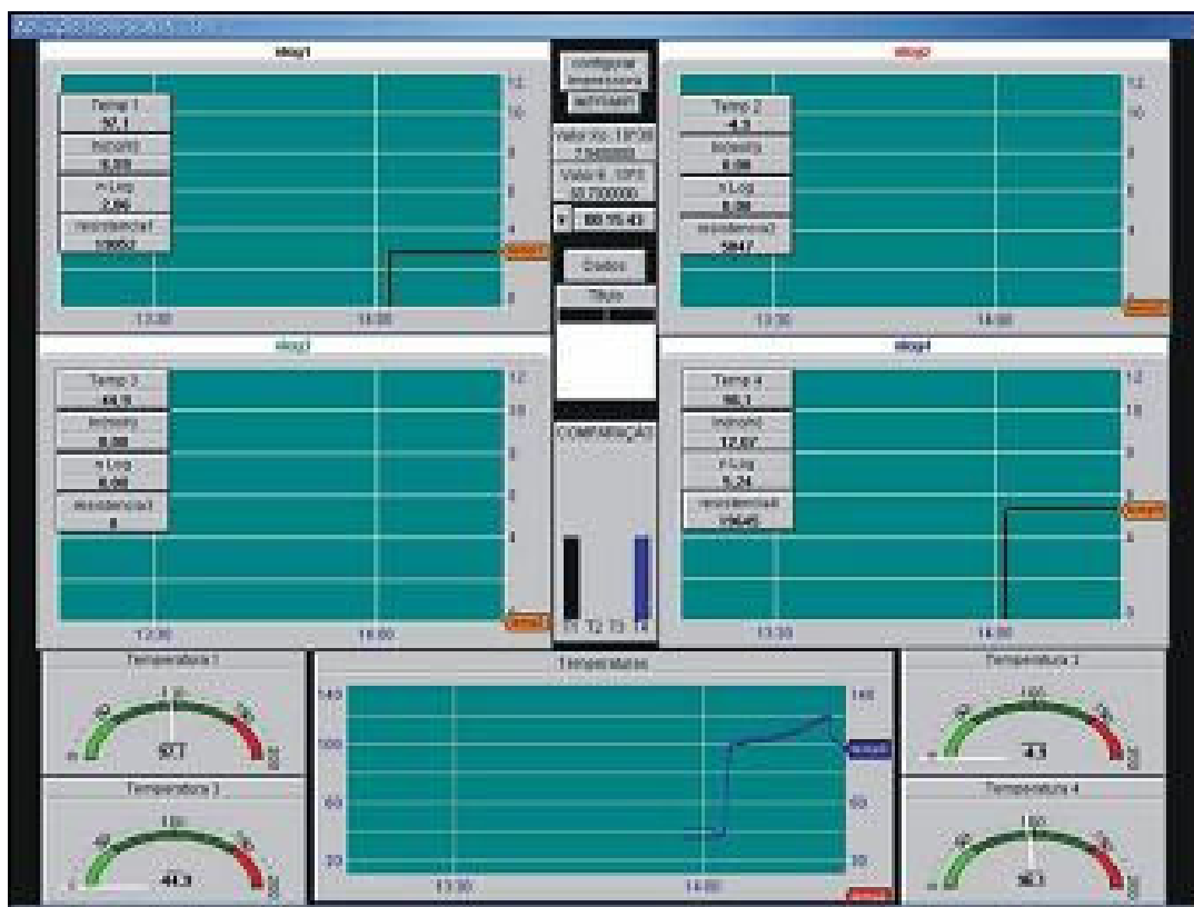
Figura 25 – Tela principal do supervisório Elipse Scada.
