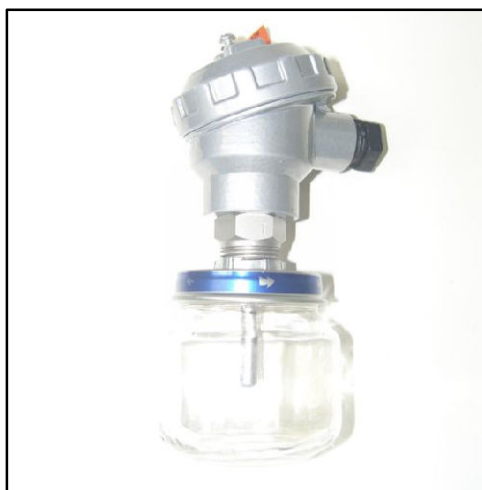
Figura 32 – Recipiente para monitoramento de temperatura e validação do modelo de destruição térmica.
