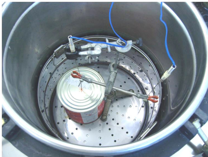
Figura 31 – Posicionamento dos termopares na esterilização da lata.
