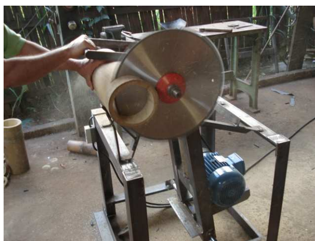
Figura 48 - Topejadora com capacidade para diâmetro de até 170 mm. Fonte: LATIC
