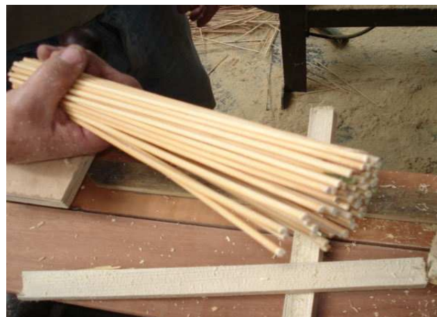
Figura 51 - Aparelhamentos longitudinais em plaina moldureira.
