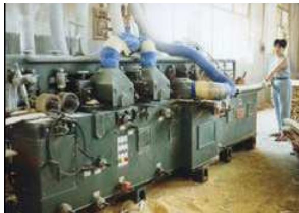
Figura 36 – Aparelhamento das lâminas de bambu.
