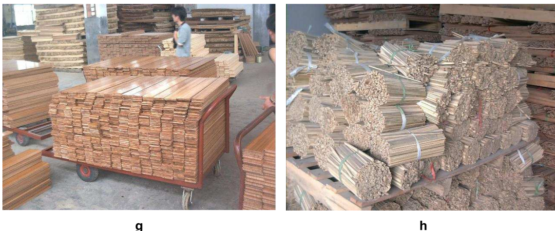
Figura 45 – Piso de BLC e palitos de bambu.
