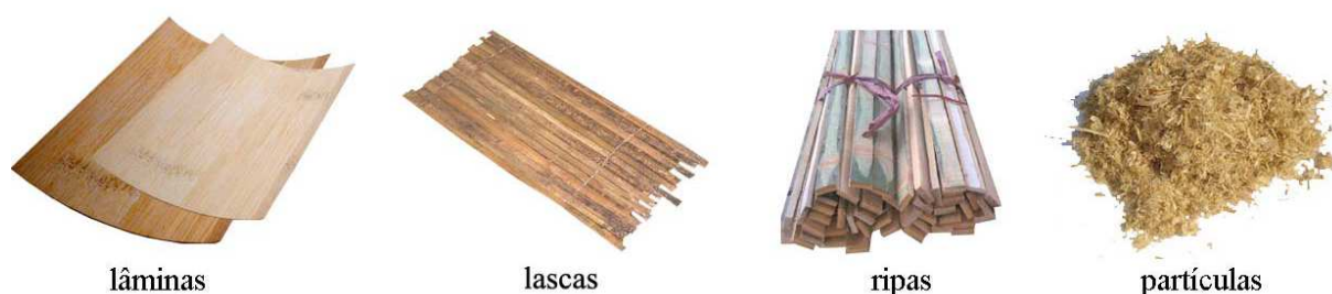
Figura 31 - Lâminas, lascas, ripas ou partículas de bambu. Fonte: MOIZÉS, 2007, p.46.
