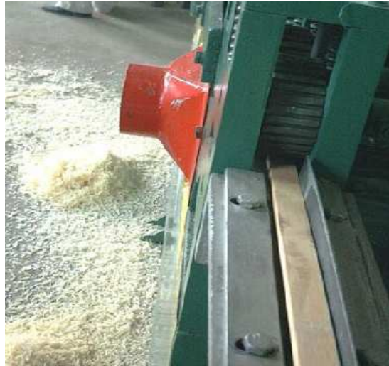
Figura 54 - Obtenção de encaixe macho-fêmea. Fonte: MOIZÉS, 2007, p.39.
