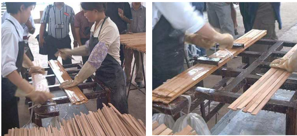
Figura 44 - Processo manual de colagem das ripas no sentido horizontal.
