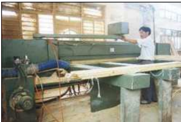
Figura 36 – Aparelhamento das lâminas de bambu.
