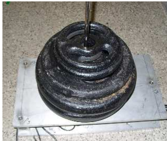
Figura 46: Aplicação de pesos em pontos específicos sobre a plataforma.
