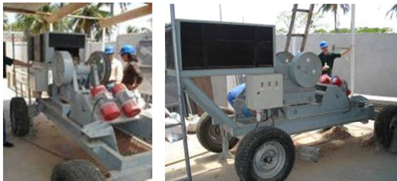
Figura 17 Equipamento móvel de britagem (LORDÉLO, EVANGELISTA e FERRAZ, 2007)
