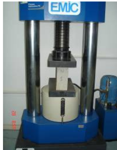
Figura 39 Ensaio de resistência à compressão – Estudo de Caso 2
