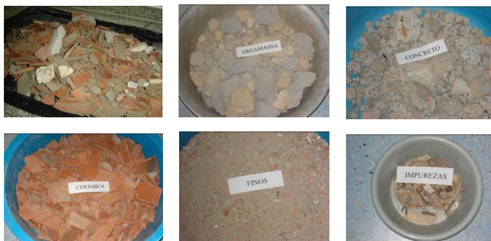
Figura 25 Análise gravimétrica do resíduo classe A - Estudo de Caso 1
