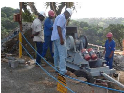
Figura 34 Instalação do britador móvel – Estudo de Caso 2
