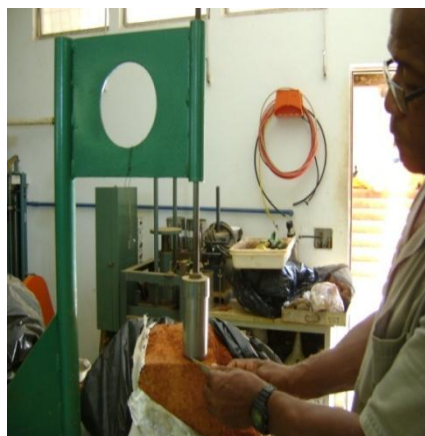
Figura 15 (b) – Procedimento de talhagem de corpos de prova indeformados.
