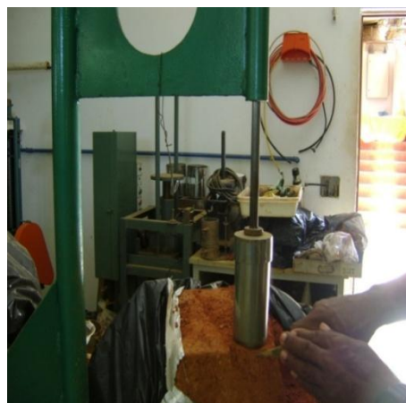
Figura 15 (d) – Detalhe da utilização da faca no corte do excesso de solo na borda do molde durante o processo de talhagem do corpo de prova.
