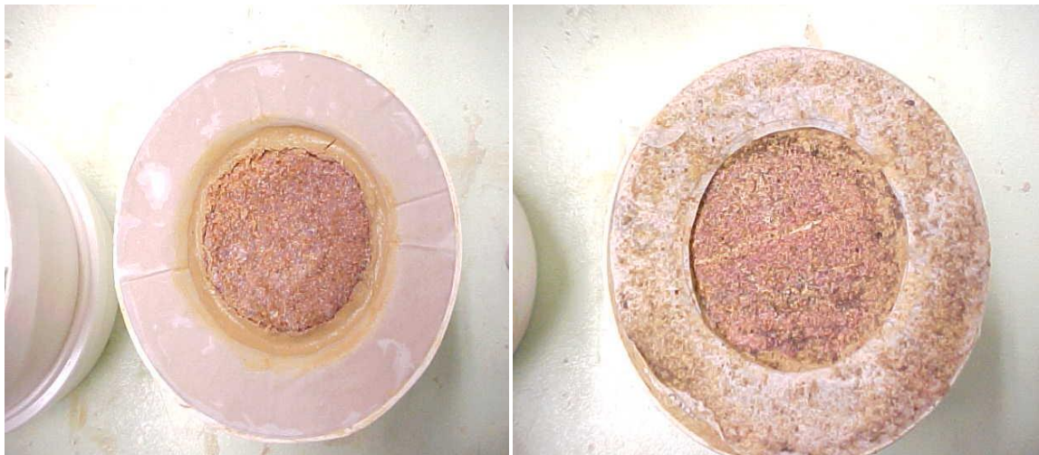
Figura 39 (a) – Corpo de prova antes da infiltração pelo efluente.
