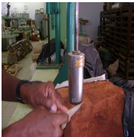
Figura 15 (c) – Vista do torno manual e do molde posicionado no topo do bloco, início do procedimento de talhagem do corpo de prova.
