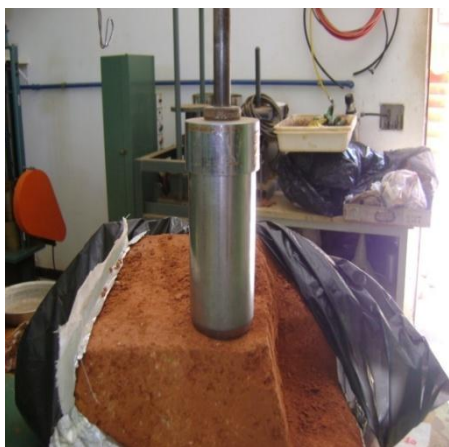
Figura 15 (a) – Bloco indeformado, área livre da parafina para início do processo de talhagem; molde utilizado para talhar os CP.
