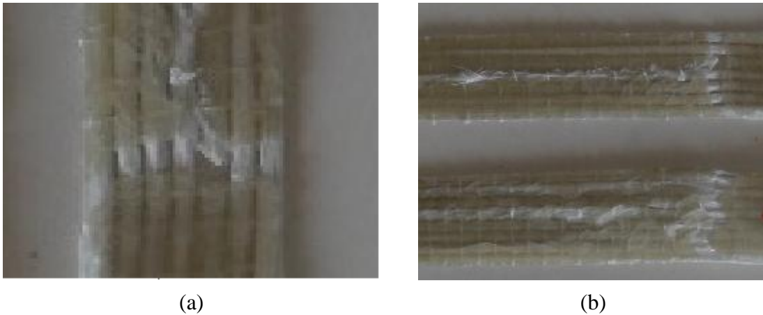
Figura 27 a) e b): Corpos de prova em fibra de vidro ensaiados à tração com fibras alinhadas na direção axial [0,0]
