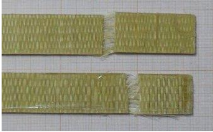
Figura 25: Corpos de prova com tecidos dispostos [0,90]
