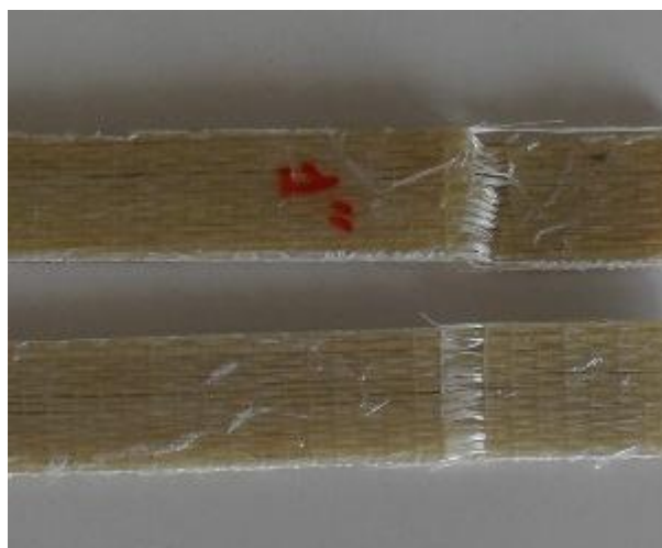
Figura 21: Corpos de prova de compósitos com fibra de sisal após ensaios de tração
