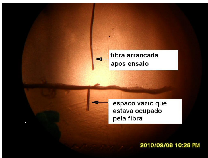
Figura 28: Corpo de prova de ensaio de arrancamento. Fotografia de microscopia óptica
