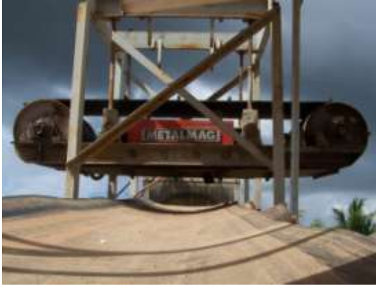
Figura 44. Imã Permanente Automático – Usina “B”.
