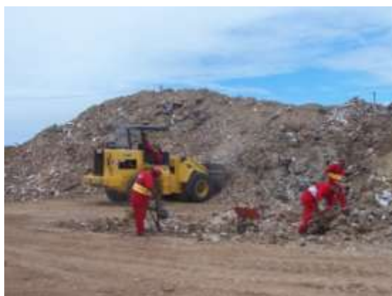
Figura 34. Coleta, espalhamento de RCC e triagem manual de resíduos – Usina “C”.
