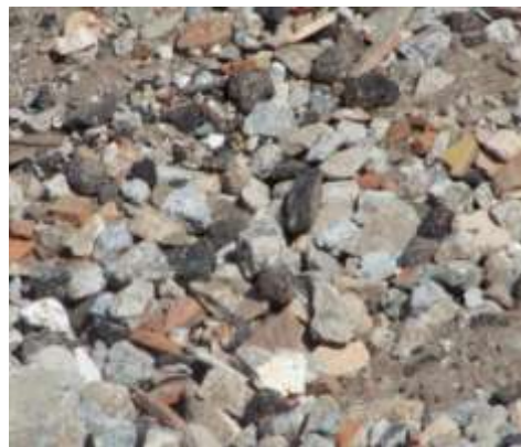
Figura 63. Agregado reciclado da usina “D”.
