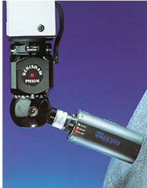
Figura II.3: sensor localizador sem contato a laser.
