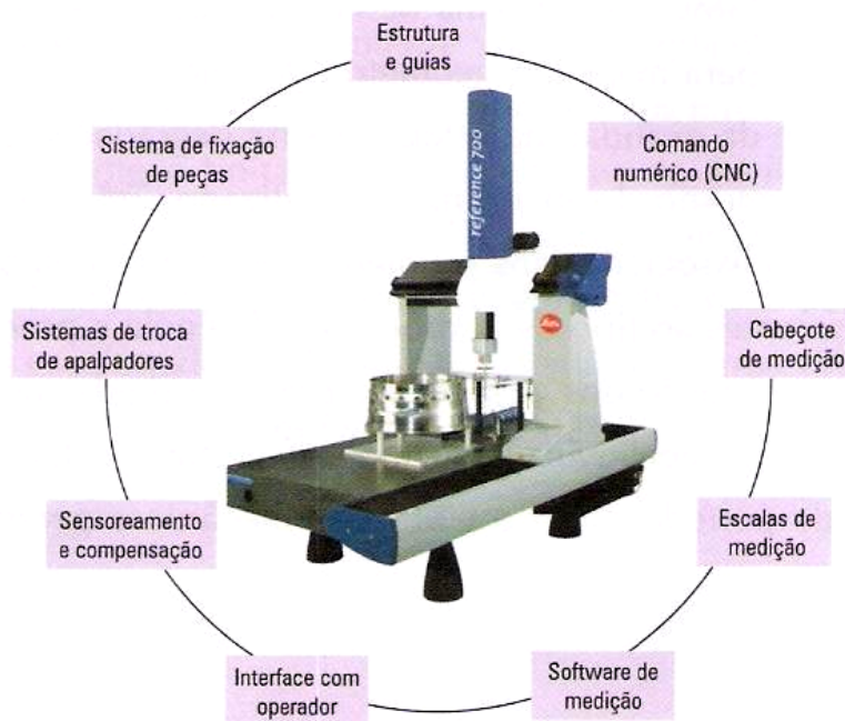
Figura II.1: subsistemas de uma MMC.
