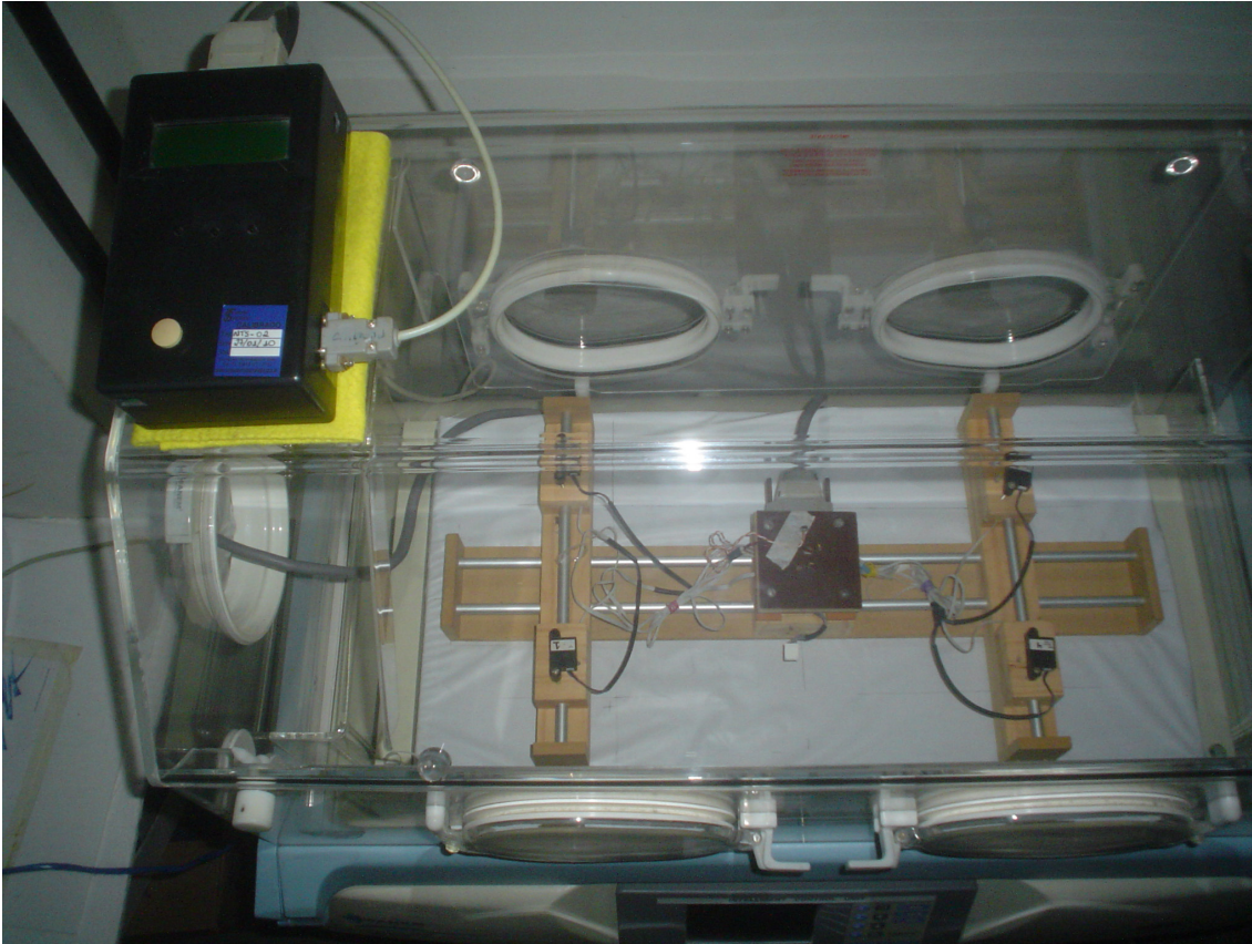
Figura 5.3: Fotografia do protótipo analisador de incubadoras e sua estrutura de posicionamento dos sensores.
