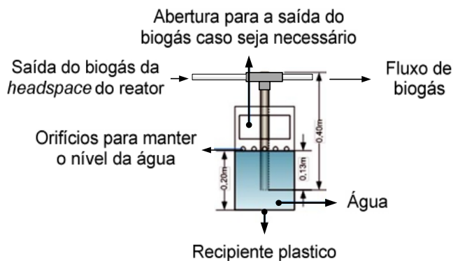
Figura 21: Válvula de segurança. Fonte: Adaptado de [19,97].
