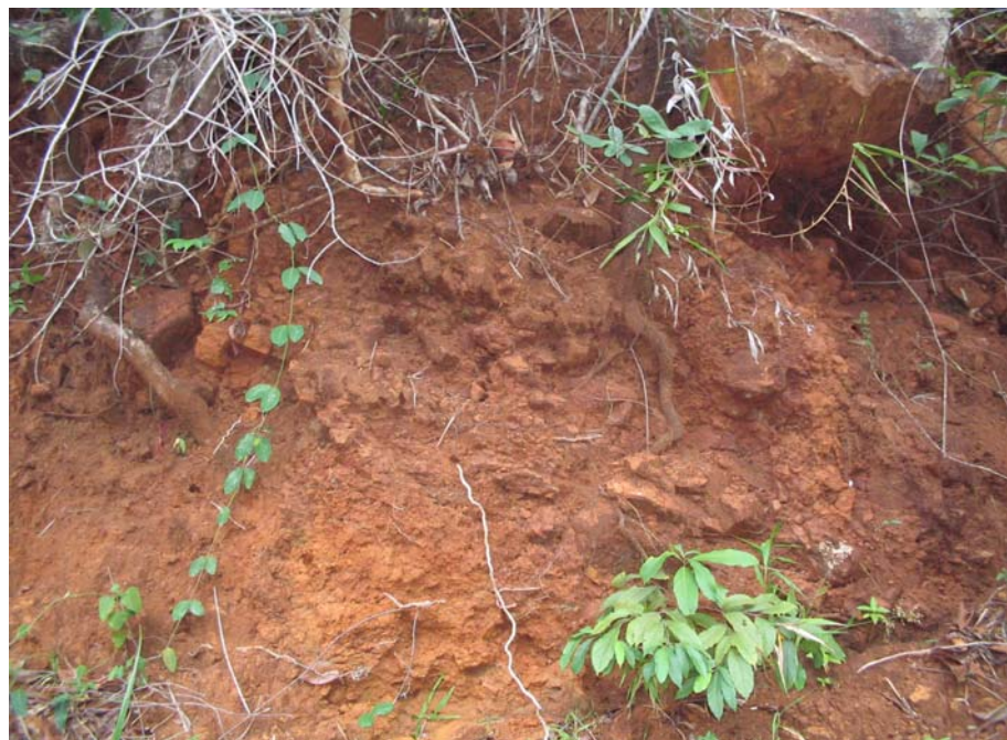
Figura 34 – Perfil do solo pouco profundo, pedregoso, com matéria orgânica em corte na margem esquerda do Rio do Ouro.
