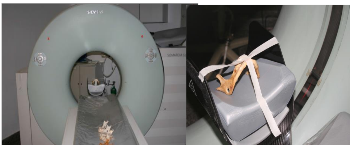
Figura 7: Posicionamento da mandíbula no aparelho de TC singleslice (SOMATOM Spirit®)
