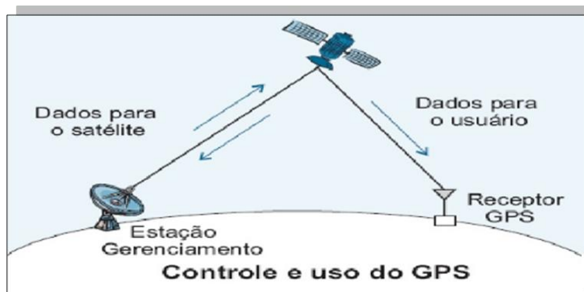
Figura 10 – Transmissão de dados entre os segmentos do GPS Fonte: Alves (2006).
