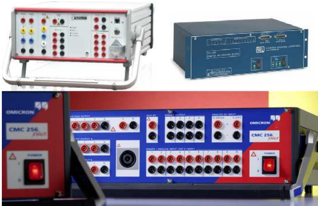
Figura 2.2: Caixa de teste de relé OMICRON, PONOVO e SEL.
