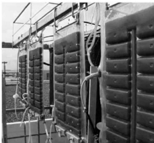
**Figura 2.7** - Fotobiorreator de placas da *Subitec*. Fonte: adaptado de Morweiser et al. (2010).
