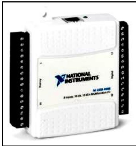
Figura 20. Dispositivo DAQ NI USB-6008 utilizado para aquistar os sinais de medição.
