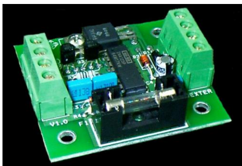
Figura 17. Amplificador de tensão utilizado para condicionar a saída elétrica da célula de carga.
