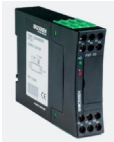
Figura 14. Conversor de frequência-tensão utilizado para condicionar o sinal de saída do sensor indutivo.
