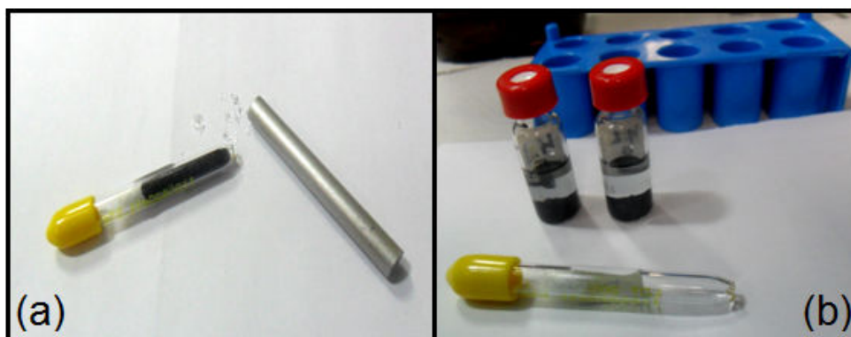
Figura 12. Procedimento de rompimento dos tubos amostradores (a) e de dessorção dos compostos BTEX do carvão ativado utilizando solvente (b).
