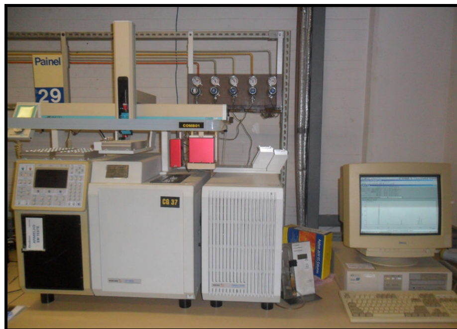
Figura 5. Cromatógrafo a gás com detector de ionização em chama, Modelo 3800 da Varian.
