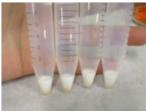
Figura 15: ZnS obtido pelo método sonoquímico
