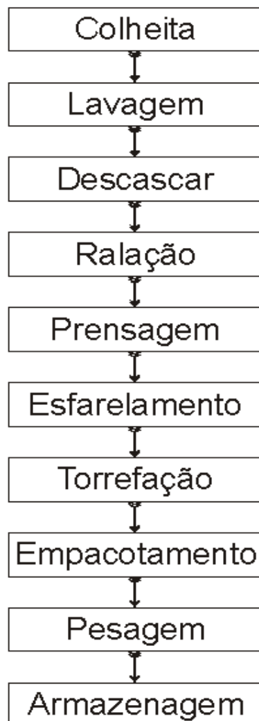
Figura 1. Fluxograma das etapas de processamento da farinha de mandioca.
