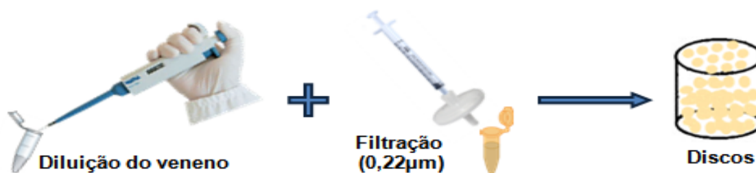
Figura 5 - Preparação dos disco de VBL e VCC
