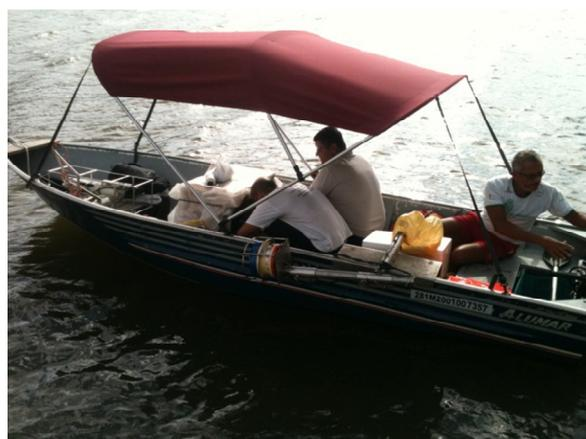
Figura 15 - Perfilador acústico ADCP e embarcação de pequeno porte com o ADCP fixado.
