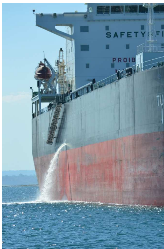
Figura 12 – Despejo de água de dentro dos navios (Foto: Lívia Gonçalves, 2013).
