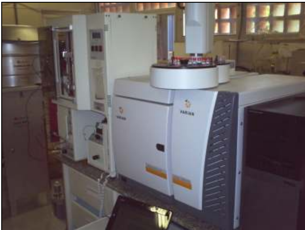
Figura 11. Autosampler Dynatherm (TDA) com interface para cromatógrafo gasoso (431-GC) acoplado com espectrômetro de massas (200-MS IT).
