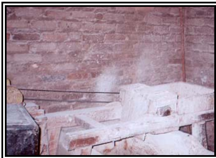
Figura 15. Máquina utilizada pelos agricultores para ralar a mandioca. Foto realizada pela autora em 2006.
