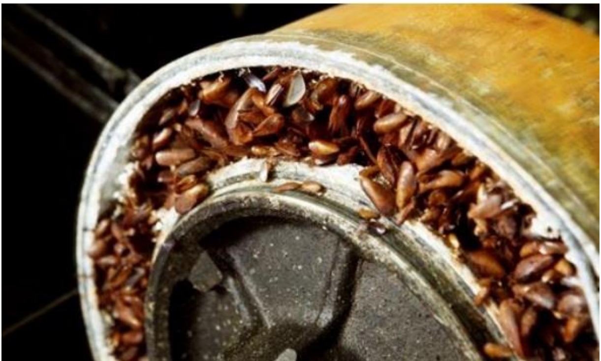
Figura 4. Mexilhões dourados incrustados em um motor de bomba de água. Fonte: ITAIPU, (2002).
