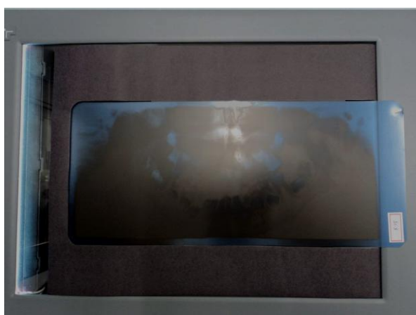
Figura 8: Papel preto apoiado na mesa do scanner com abertura da mesma dimensão do filme panorâmico
