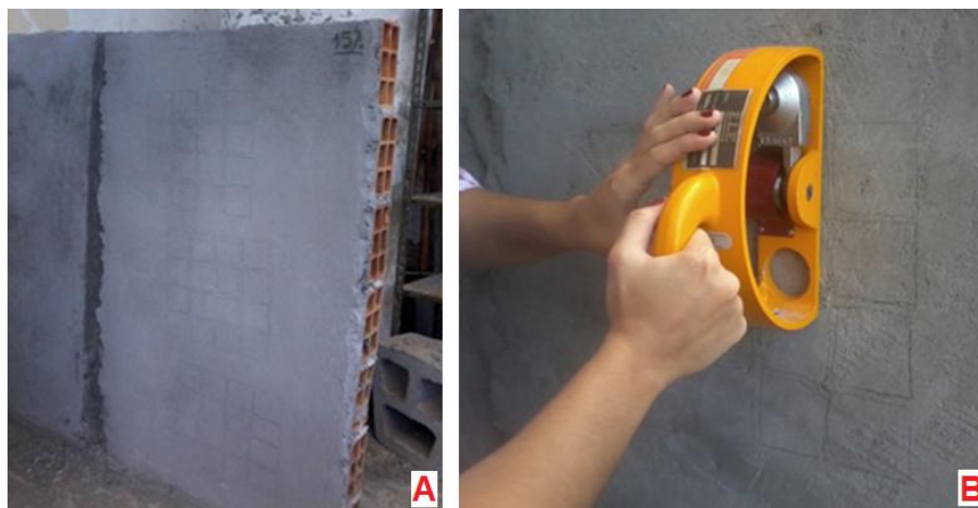
Figura 35: Processo de ensaio por meio do esclerômetro de reflexão, A) Painel com as demarcações da área de ensaio, B) Esclerômetro sendo utilizado no painel durante o ensaio.
