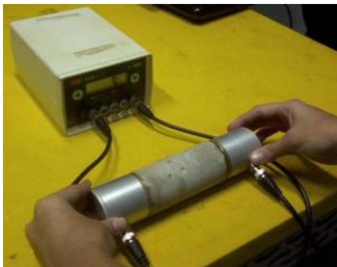
Figura 27: Ensaio realizado pelo aparelho de medição de pulso ultrassônico com corpo de prova cilíndrico.
