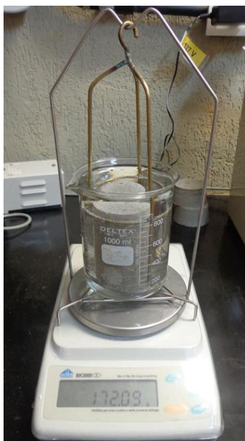
Figura 28: Determinação de massa de um corpo de prova submerso em água.
