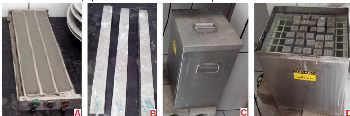
Figura 31: Sequência do ensaio de RAA, A) Formas prismáticas preenchidas com argamassa, B) Corpos de prova desmoldados após 24 horas de cura, C) Vista externa do banho de água destilada, D) Vista interna do banho em solução de hidróxido de sódio.
