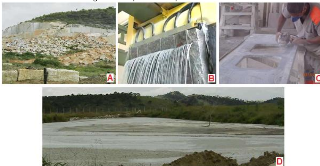
Figura 2: Fotos referentes às etapas geração do RCMG; A) Extração das rochas na pedreira, B) Corte dos blocos de rocha na serraria, C) Acabamento final na marmoraria, D) Depósito de lama gerado nas pedreiras depositado a céu aberto.
