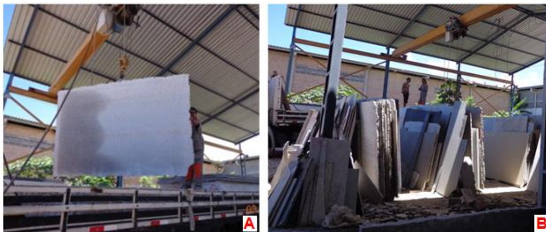
Figura 11: Etapas do processo de chegada de chapas brutas na marmoraria, A) Chegada das chapas, B) Depósito das chapas brutas.
