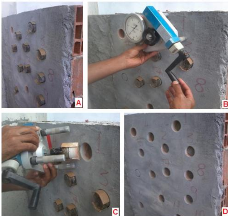
Figura 36: Sequência de ensaio de arrancamento de corpos de prova do painel, A) Pastilhas de metal coladas no painel, B) Posição de ajuste do dinamômetro às pastilhas de metal para início do ensaio, C) Fim do ensaio com a amostra do painel após o arrancamento, D) Painel após o arrancamento de todos os corpos de prova.
