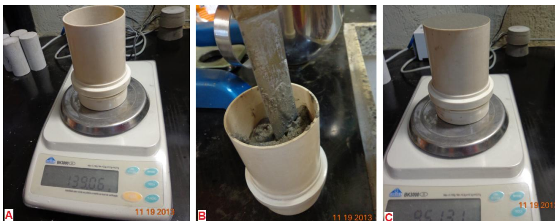
Figura 24: Etapas do ensaio de densidade no estado fresco, A) Recipiente vazio, B) Recipiente com argamassa durante o adensamento, C) Recipiente com argamassa após o adensamento.
