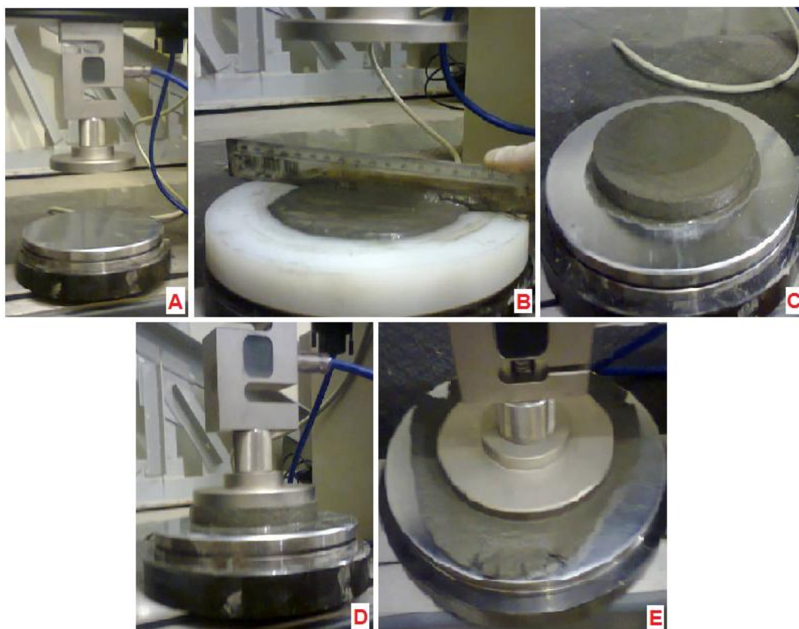
Figura 18: Sequência do ensaio de squeeze-flow , A) Base para a argamassa com a punção, B) Forma preenchida com argamassa, C) Argamassa após a retirada da forma, D) Base com argamassa e a punção na posição de início de ensaio, E) Argamassa após a compressão.
