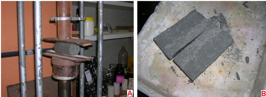
Figura 26: Ensaio de resistência a compressão diametral, A) Corpo de prova cilíndrico antes do ensaio, B) Corpo de prova rompido após o ensaio.
