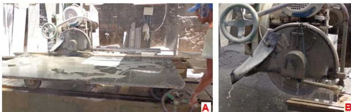
Figura 12: Processo de cortes lineares em serras de diamante, A) Máquina de corte serrando a chapa bruta, B) Detalhe da serra com disco de diamante.
