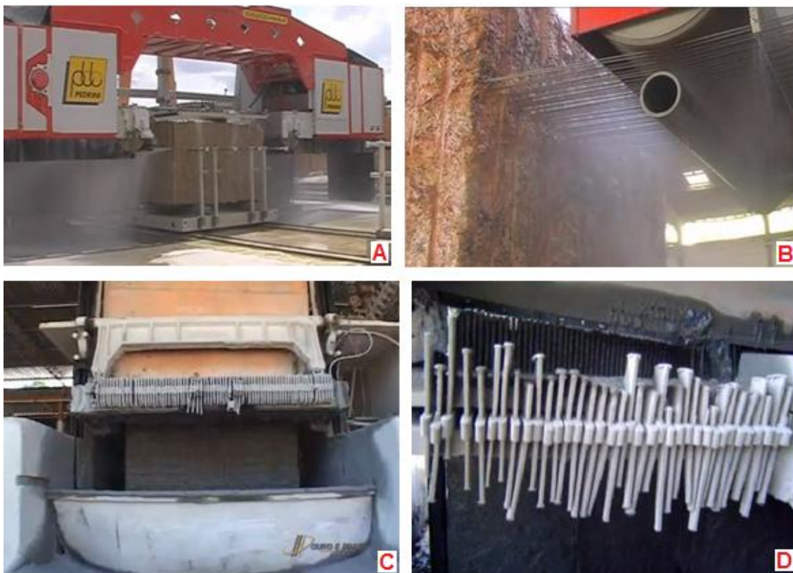
Figura 3: Tipos de teares utilizados no corte de mármore e granitos, A) Tear de fios diamantados, B) Corte da rocha com tear de fios diamantados, C) Tear composto por multilâminas de aço, D) Vista aproximada das multilâminas de aço.
