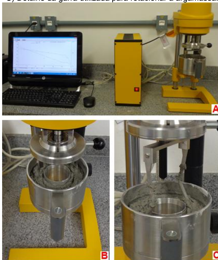
Figura 19: A) Componentes do reômetro ; B) Vista superior do reômetro com argamassa; C) Detalhe da garra utilizada para rotacionar a argamassa.
