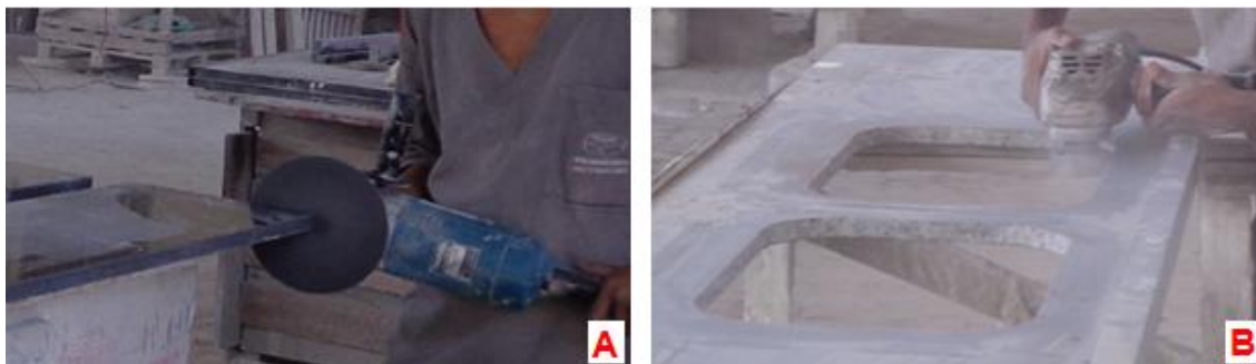
Figura 13: Processo de acabamento final na marmoraria, A) Acabamento lateral por meio de discos, B) Acabamento de cantos arredondados por meio do rebolo.
