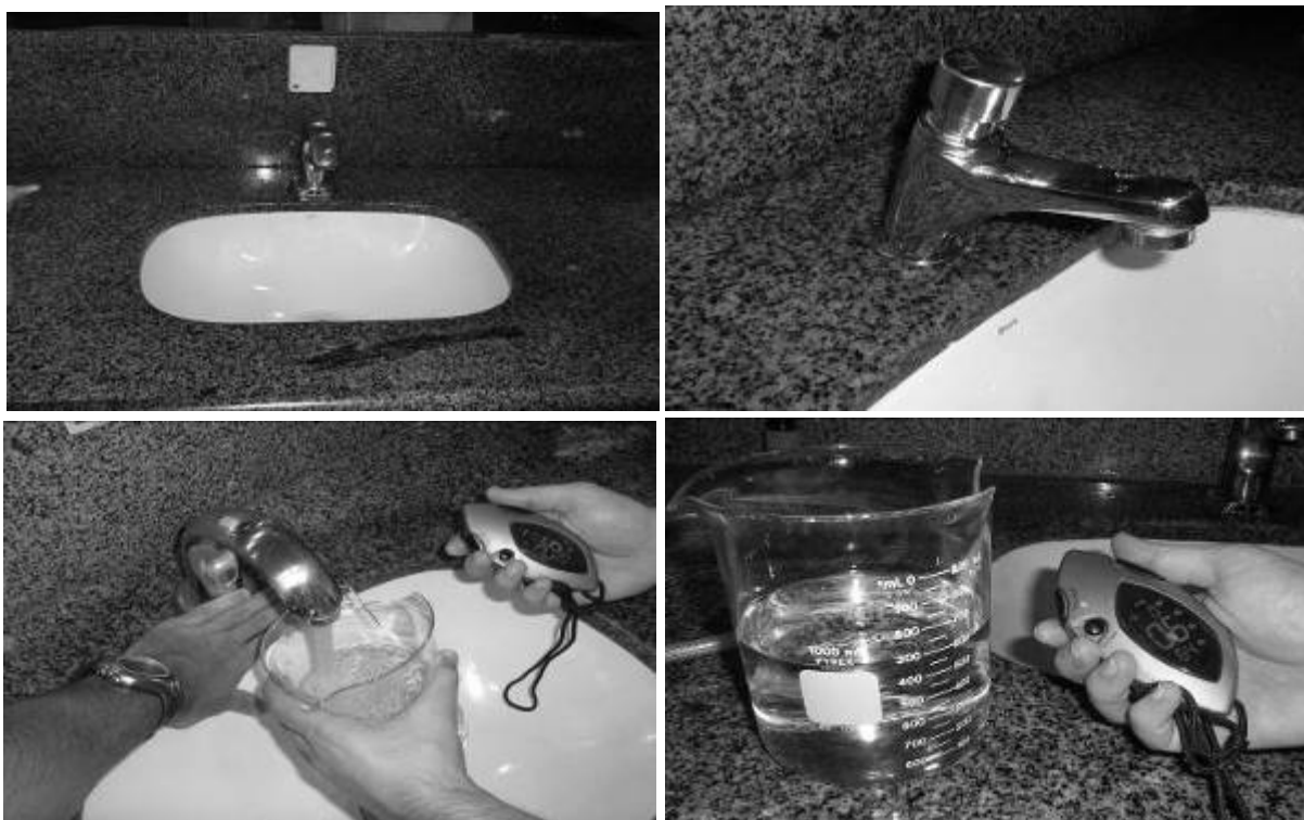
Figura 16 – Aferição do volume de água nos lavatórios
