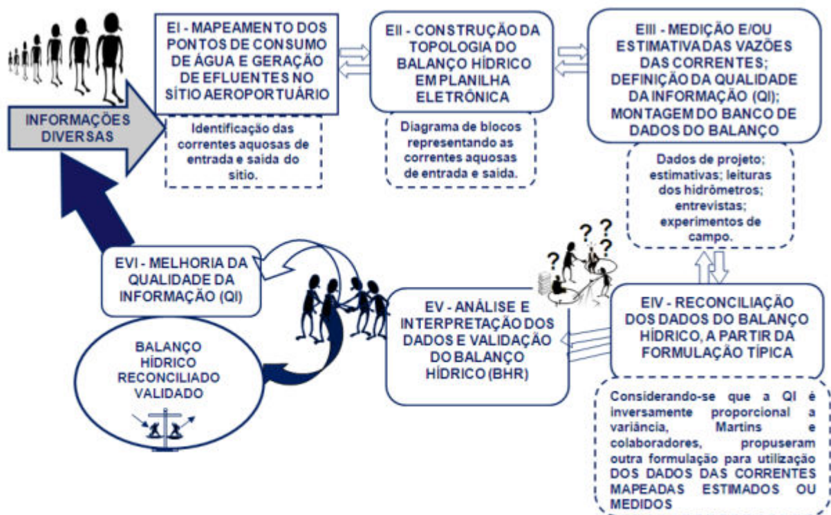
Figura 13 - Fluxograma metodológico para construção do balanço hídrico reconciliado
