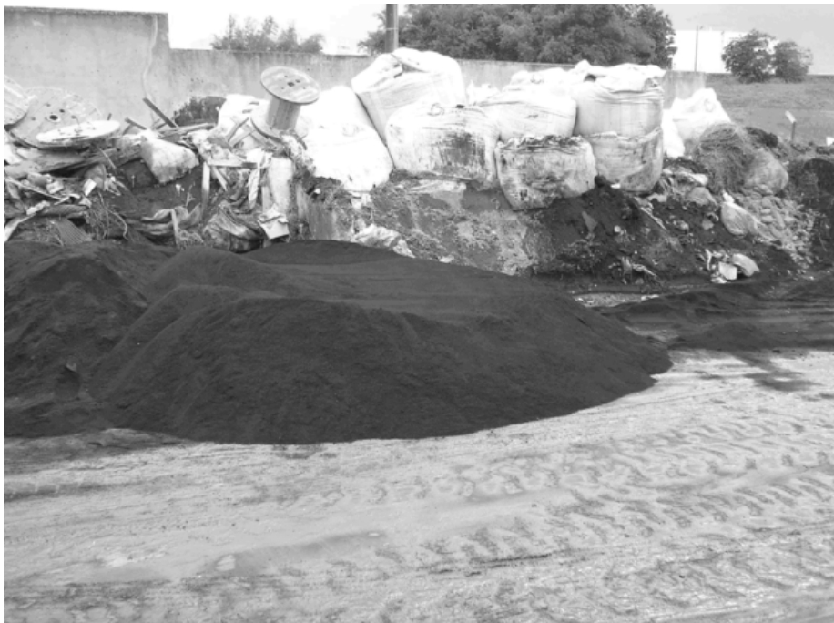
Figura 2 - Catalisador usado removido por varrição da área industrial e armazenado em local temporário da refinaria.
