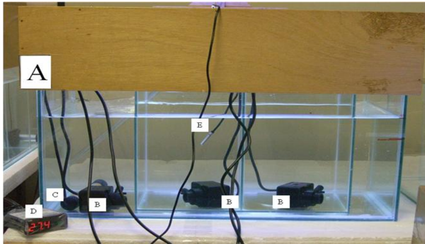
Figura 2. Equipamentos usados no sistema aquário/cuba: caixa com lâmpadas tubo fluorescente azul e branca (A), bombas de aeração (B), aquecedor (C) termostato (D) com sensor de temperatura (E).
