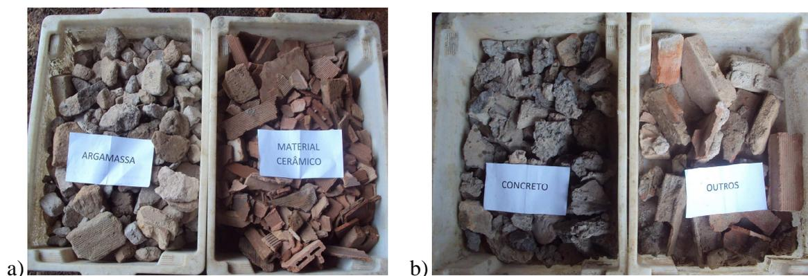
**Figura 25** - a) Frações Argamassa e Material Cerâmico; b) Frações Concreto e “Outros”.
