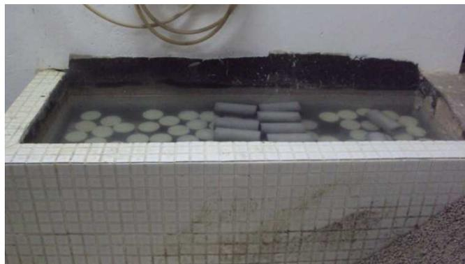
**Figura 53** – Tanque de cura.
