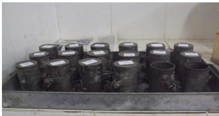
**Figura 49** – Corpos-de-prova de argamassa.
