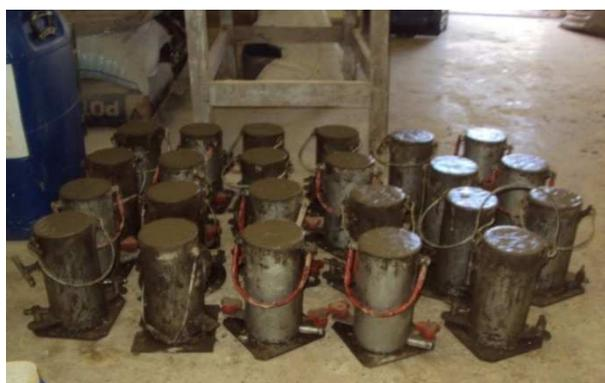
**Figura 52** – Corpos-de-prova de concreto.
