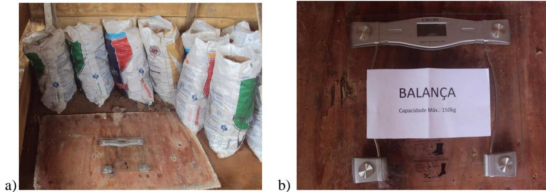
**Figura 26** - a) Sacos empilhados com as frações de entulho; b) Balança utilizada na composição gravimétrica.
