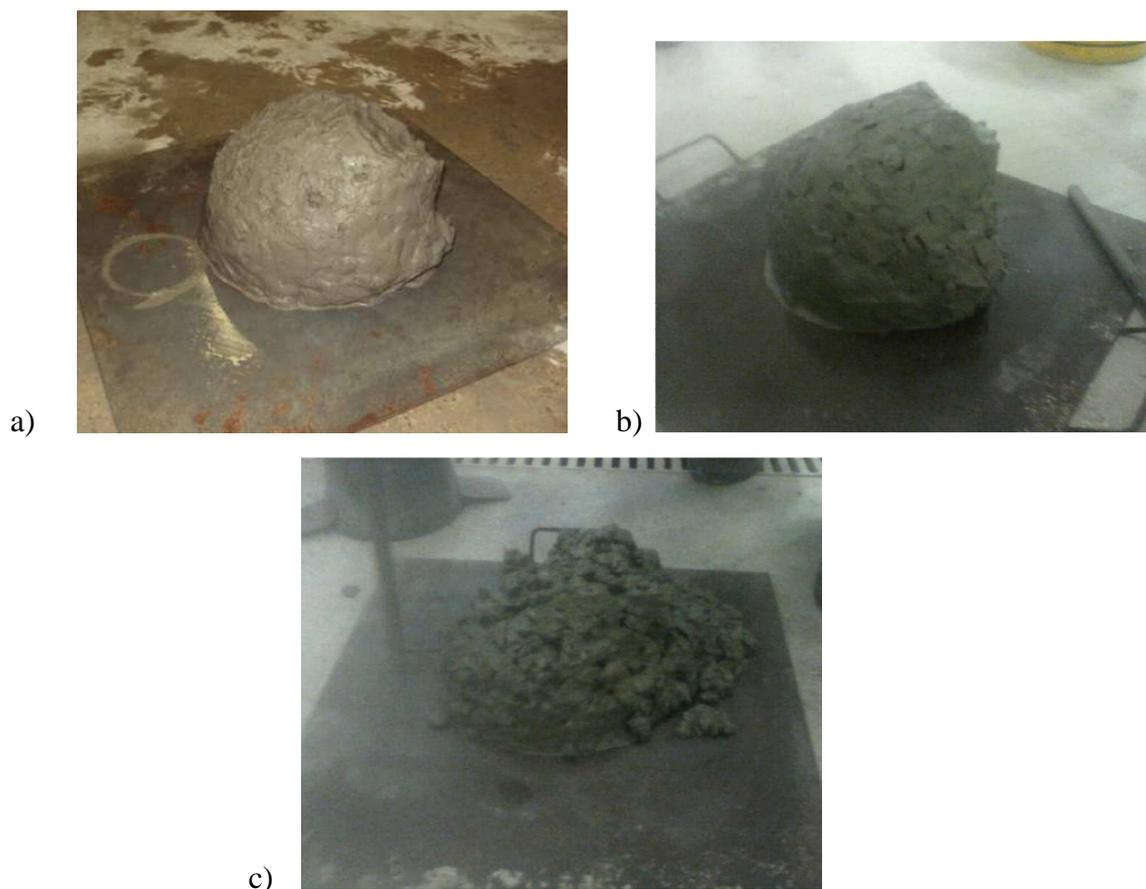
**Figura 74** – Verificação da coesão da mistura. a) Método IPT/EPUSP; b) Método Mehta/Aitcin e c) Método ACI/ABCP.
