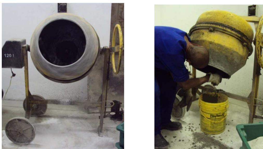
**Figura 50** – Betoneira utilizada para confecção das misturas de concreto.
