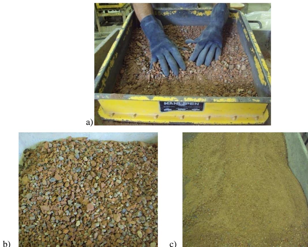
**Figura 29** - a) Peneiramento #4,75 mm; b) Fração retida; c) Fração passante.
