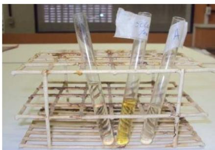
**Figura 33** – Ensaio de Impurezas Orgânicas.
