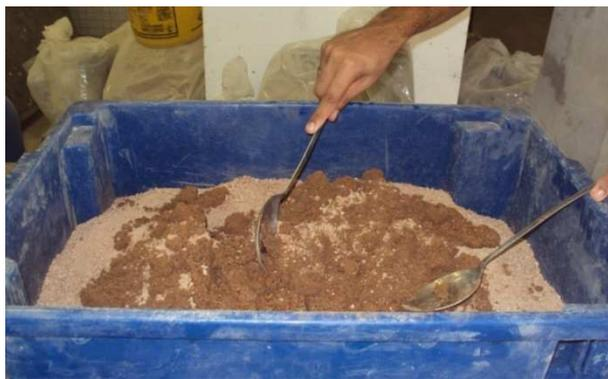
**Figura 46** – Pré-umedecimento do agregado miúdo reciclado.
