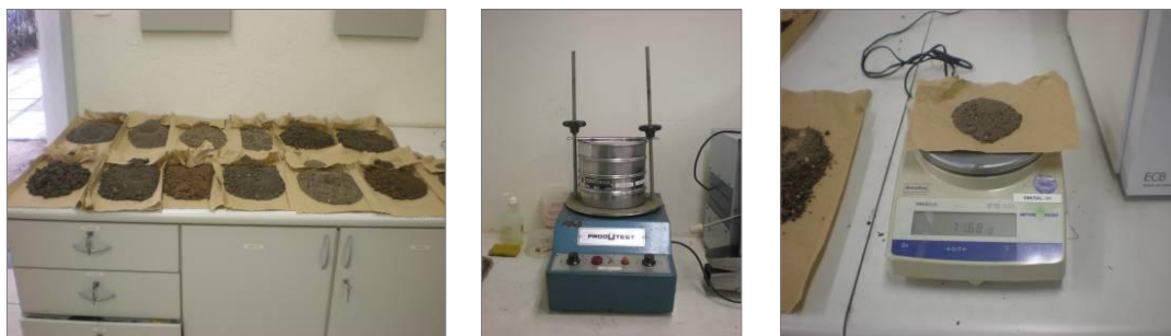
Figura 02: Secagem de amostras de solo peneiramento e controle de peso
