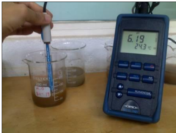
Figura 3.9 - Mensuração de pH do solo
