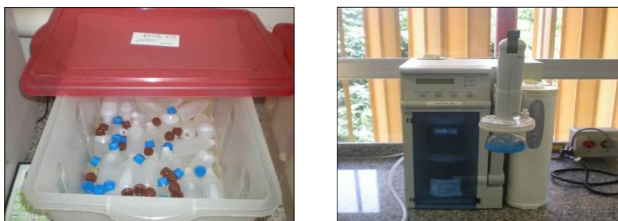
Figura 03: Descontaminação de materiais (1) solução de \text{HNO}_3 10%; (2) Equipamento para gerar água Mili-Q
