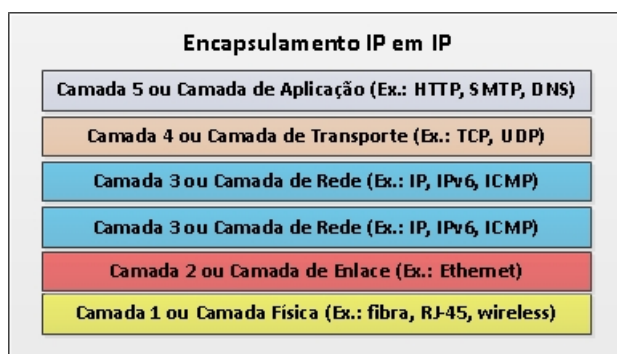
Figura 2.8. Encapsulamento IP em IP na Pilha TCP/IP.
