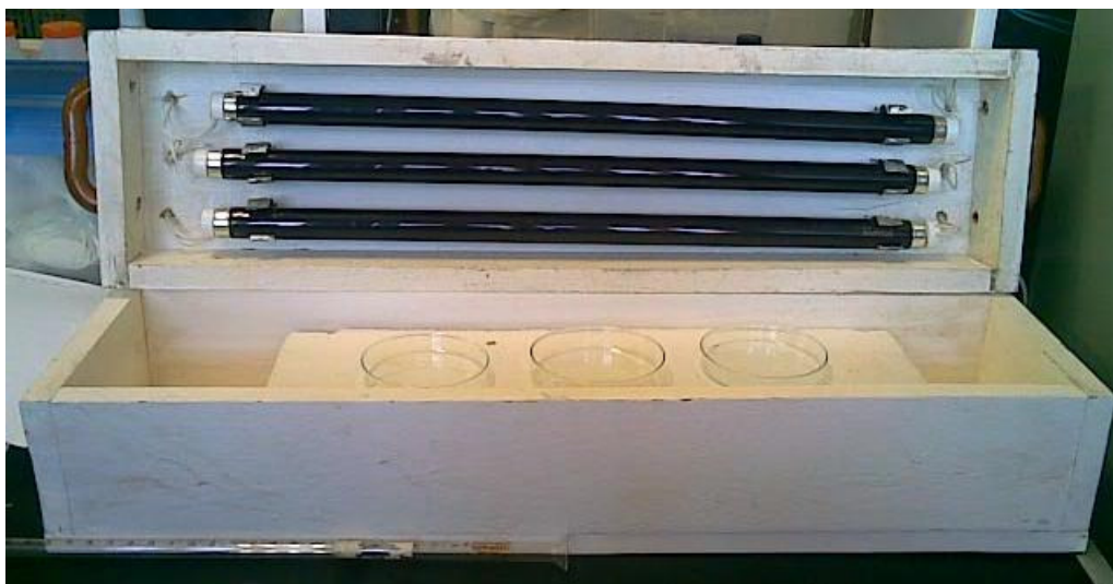
Figura 11. Foto-digestor UV utilizado para a fotodegradação das amostras de vinho.
