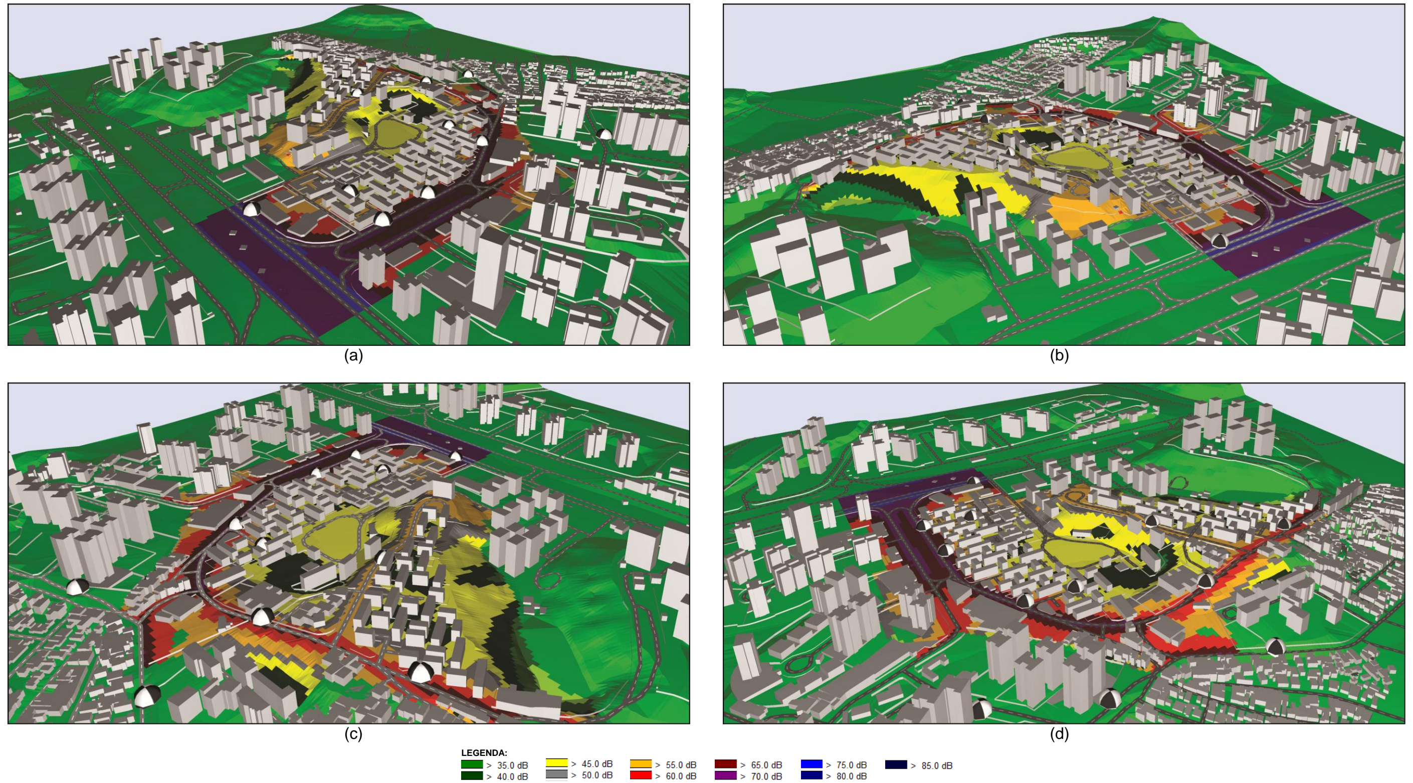
Figura 62 – Vistas 3D dos Mapas Acústicos Plano Horizontal - Lden (day + evening + night, duração de 24 horas) - Níveis de Ruído Calculados: (a) Vista Sudeste; (b) Vista Sudoeste; (c) Vista Noroeste; (d) Vista Nordeste.
