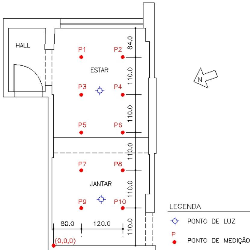
Figura 4.9 – Pontos de medição dos níveis de iluminamento natural
