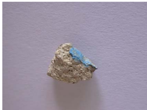
Figura 129: Imagem da amostra 3C. Observa-se a camada de azul bastante intenso. Foto da autora.
