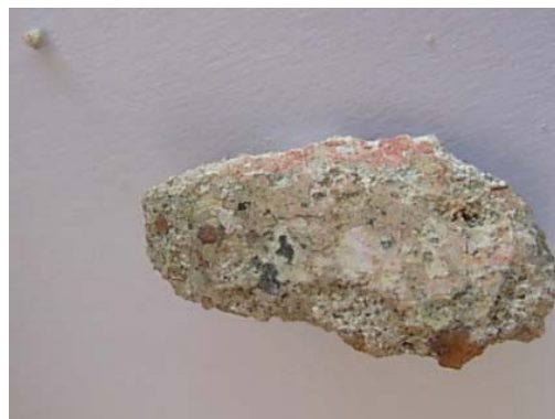
Figura 144: Amostra 11B. Nota-se a camada rosada na parte superior. Foto da autora.
