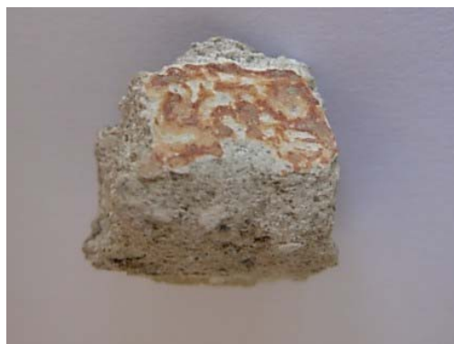
Figura 148: Amostra 14C. Vêm-se os pontos alaranjados sob tinta a vermelha. Foto da autora.
