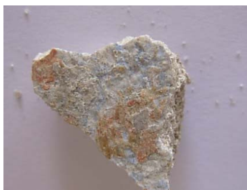
Figura 125: Amostra 7A, percebe-se a camada de azul bem clara e acinzentada. Foto da autora.
