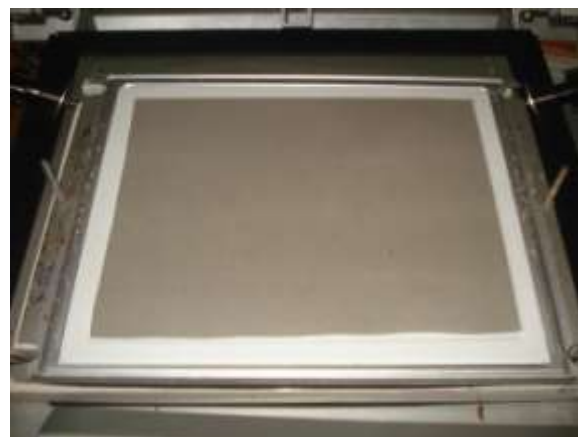
Figura 13: Filtros de quartzo antes e após a coleta de material particulado
