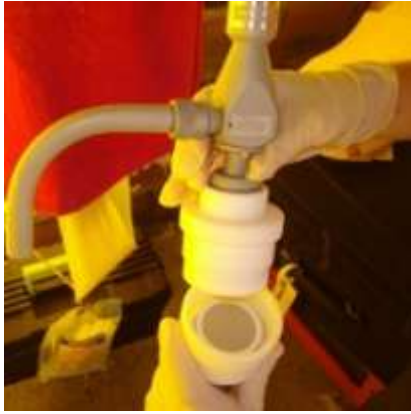
Figura 14: Membrana de teflon e resina de XAD 4 após coleta de material
