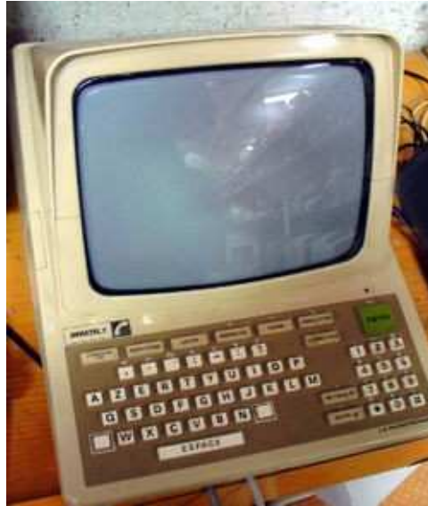
Figura 15 - O Minitel I foi um dos aparelhos utilizados para se acessar o sistema desenvolvido na França. Fonte: http://en.wikipedia.org/wiki/Videotex . Out.2006.
