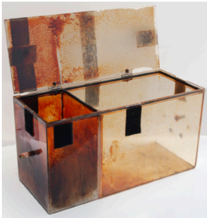
Figura 13 e 14. Caixa acrílica utilizada para exposição dos espécimes ao final do experimento. Note a impregnação proveniente da fumaça do cigarro.
