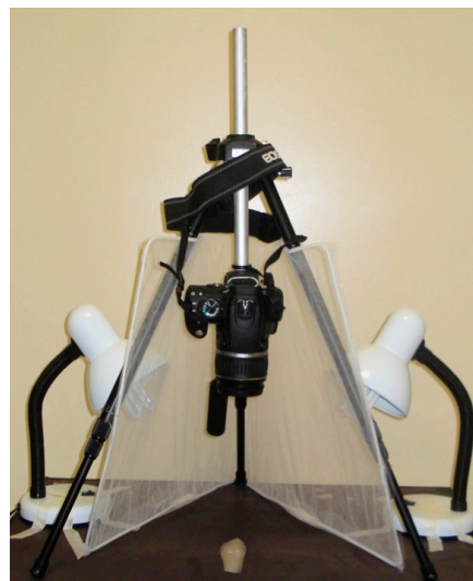
Figura 12. Estativa utilizada para realização das fotografias, composta de maquina fotográfica acoplada a um tripé, duas luminárias com lâmpadas fluorescentes, difusores e base de suporte.
