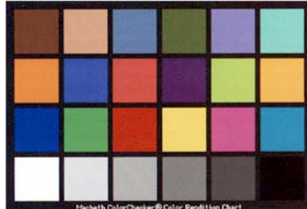
Figura 11. Cartão GretagMacbeth ColorChecker com 24 amostras utilizado para a calibração da câmera digital e padronização das fotografias.
