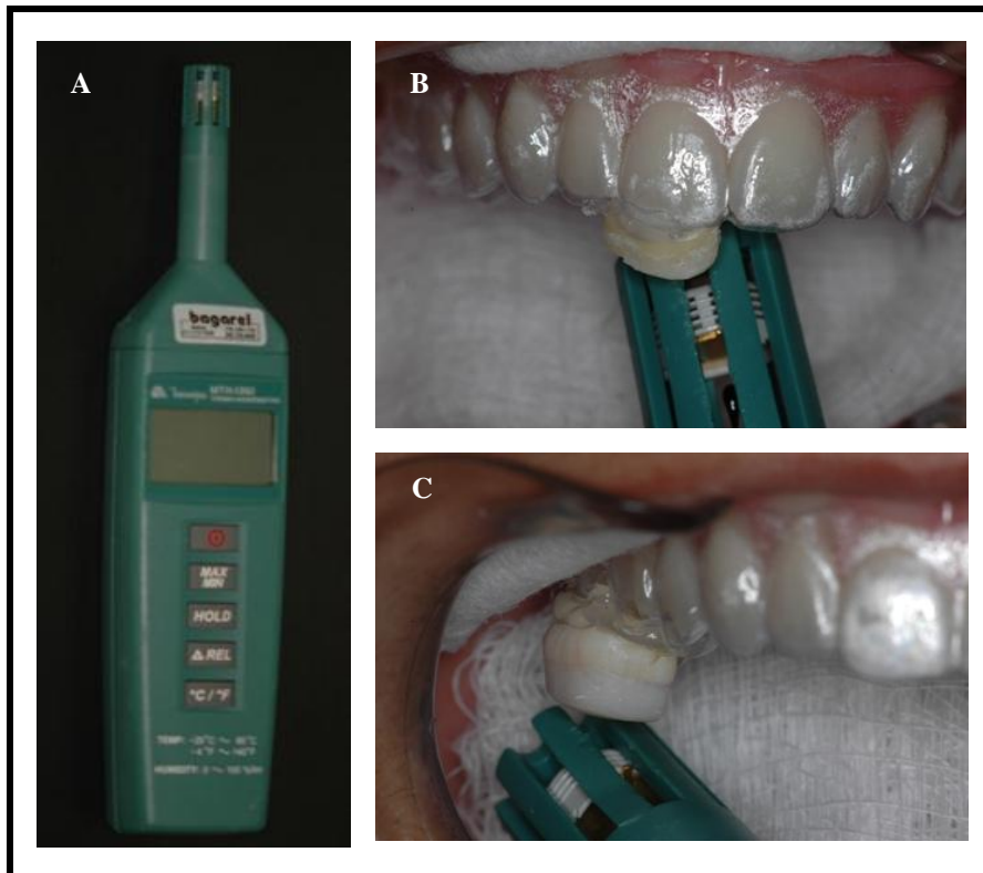
Figura 05 – (A) Termo-higrômetro digital (MTH – 1361, Minipa Indústria e Comércio Ltda., São Paulo, SP, Brasil); (B) Mensuração das condições de temperatura e umidade nas regiões de incisivos e molares superiores (C).
