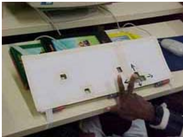
Fig. 8 - Máscara de teclado com poucas teclas expostas
