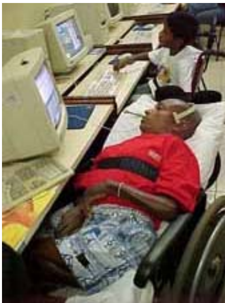
Fig. 15 - Comandando o computador com sopros no microfone
