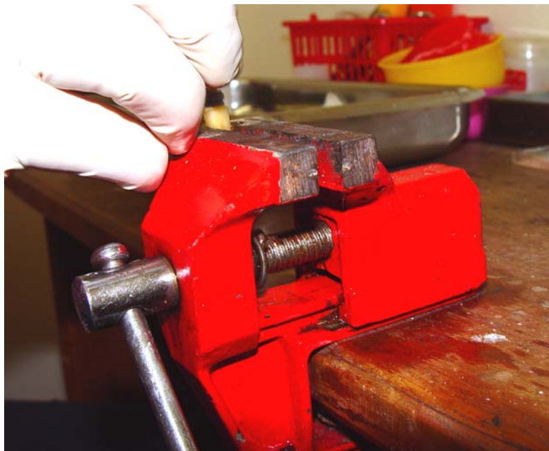
Figura 2. Morsa usada para a apreensão dos espécimes
